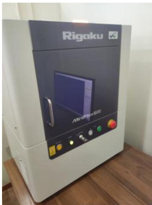
Рисунок 19 - Рентгеновский дифрактометр Miniflex 600, Rigaku
