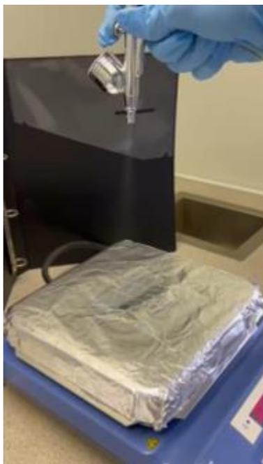
Рисунок 14 – Нанесение пленок  $\text{SnO}_2$  методом спрей-пиролиза
