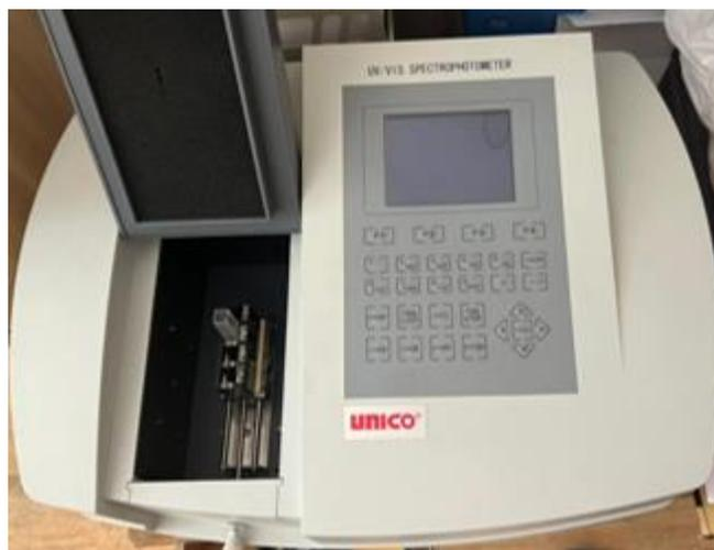
Рисунок 18 - Спектрофотометр UNICO однолучевой VV/VIS 2800
